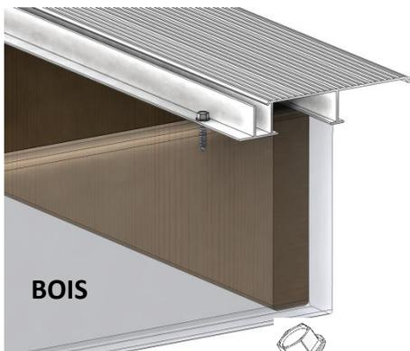
P-6 installé sur une Structure en Bois
