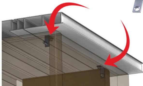
Couper les coins de la **moulure de finition M-2** à un angle de 45 degrés et fixer avec des vis #10 auto foreuses.
