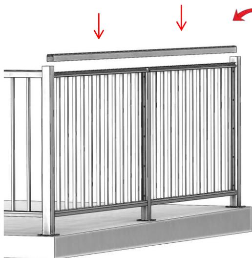
Pour terminer l'installation, clipper la main courante sur les sections.
