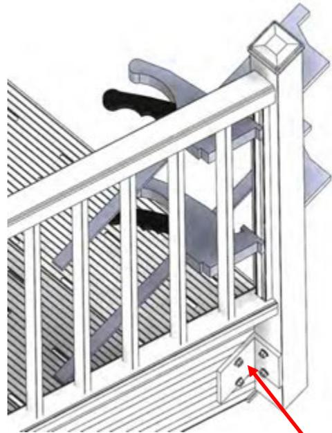
Visser l'équerre avec 2 vis dans le limon et 2 vis dans le poteau.
