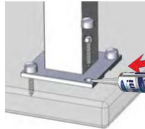
**Conseil:** Utiliser du calfeutrant ou silicone pour sceller l'installation on l'insérant dans les trous.
