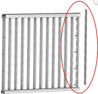
Lorsque vous commandez une rampe avec barre d'attaches, un ajustement serré est plus difficile à obtenir lorsque ce sont des colonnes de bois.
