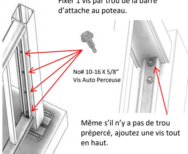
Fixer 1 vis par trou de la barre d'attache au poteau.
