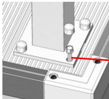
**Conseil:** Ne forcer pas les vis/boulons lorsque vous installer vos poteaux sur un plancher ou marches en aluminium.
