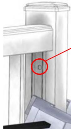
**Conseil:** Les barres d'attaches sont préperçées pour faciliter l'installation. Installer autant de vis que de trous préperçé.
