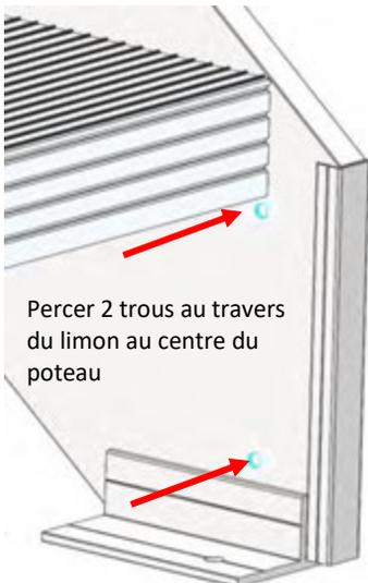
Percer 2 trous au travers du limon au centre du poteau
