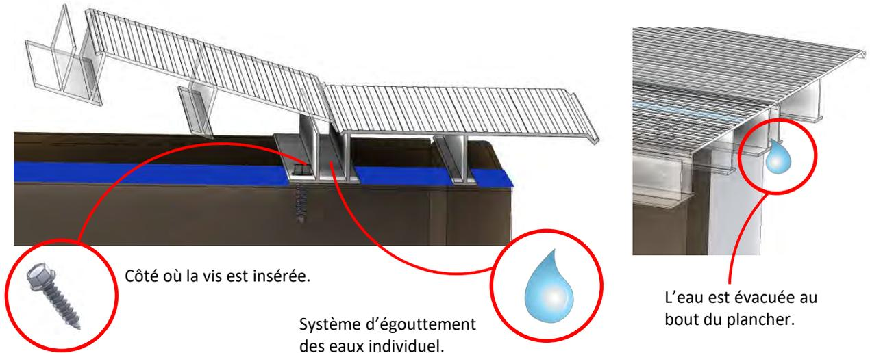
Le plancher **P-6 en Aluminium** peut être installé directement sur tous les types de structures sans la nécessité d'installer une barrière d'érosion supplémentaire. La seule différence sera le type de vis utilisée.
