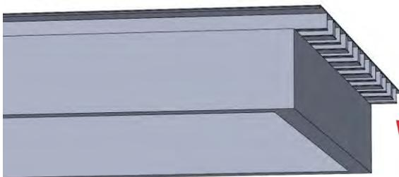
**NOTE: Vous avez besoin d'un Minimum de 2'' de dépassement A l'avant pour une évacuation Adequate de l'eau.**
