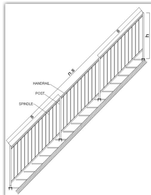
**TABLE 3 – S-500 - /** Hauteur maximale de l'escalier et nombre de marches sans colonne - **CHARGE CONSIDÉRÉE DE 1.125 kN/M**
